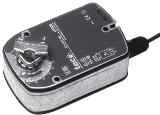
Приводы ТАС М-LF24 и ТАС М-LF230 с пружинно-возвратным механизмом (тип сигнала "открыть/закрыть") используются для управления воздушными заслонками площадью до 0.8 м<sup>2</sup>, обеспечивающими функцию защиты от заморозки, дыма, пыли и т.п.
