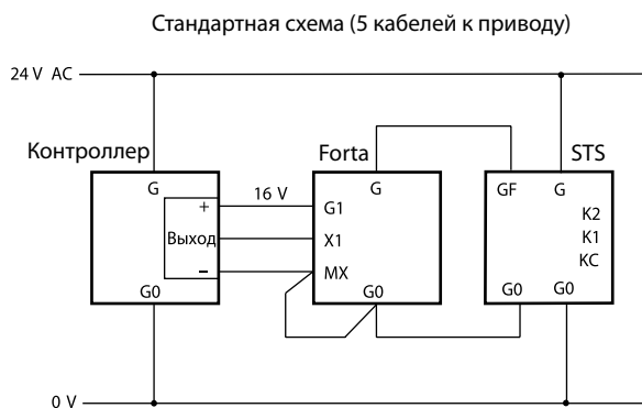
Аналоговое управление, 16 V DC питание для контроллеров (TAC 218E/RM, TAC 221L, TAC 228R/RL/RF, TAC 239W, TAC 258R/RL, TAC 268R/RL/RF)
